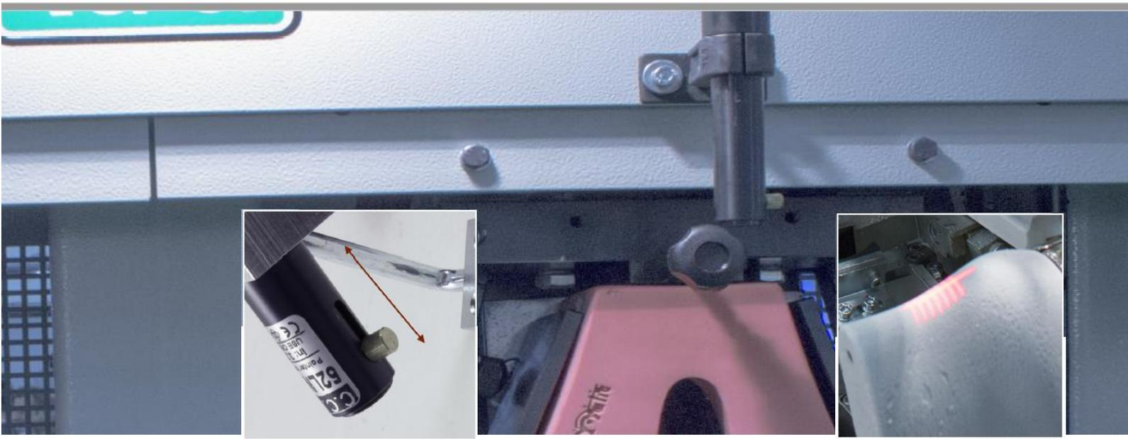
I sistemi di puntamento a LED sono stati progettati e costruiti per l'allineamento ed il posizionamento di materiali in diverse applicazioni.
