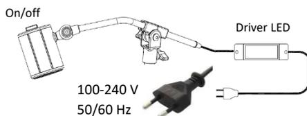
La lampada è fornita di un interruttore sulla testa che interrompe il secondario del driver LED esterno alla lampada.
